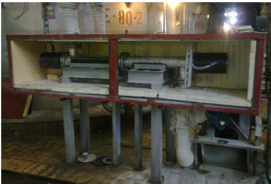
Рисунок 4.10 – Фото промышленной установки для УЗ диспергирования суспензии катализатора крекинга нефти
