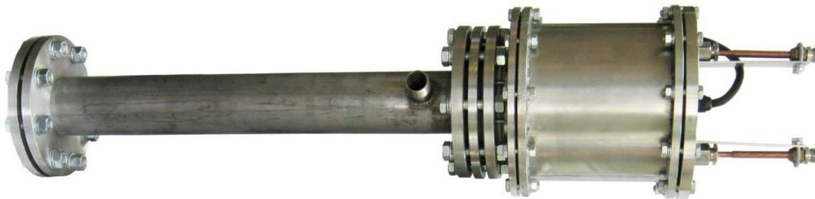
Рисунок 4.8 – Технологический объём для кавитационной обработки жидкостей с внутренними кольцевыми отражателями
