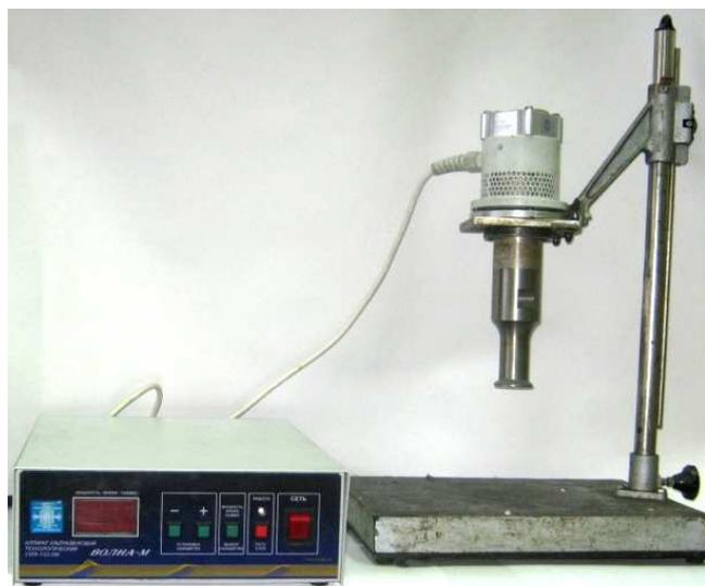
г) экспериментальный стенд для выявления зависимости энергии ударных волн и объёма зон развитой кавитации от расстояния между излучателем и отражающей границей
