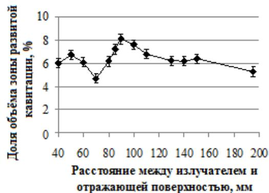
б) масло (интенсивность воздействия  $7,5 \text{ Вт/см}^2$ )
