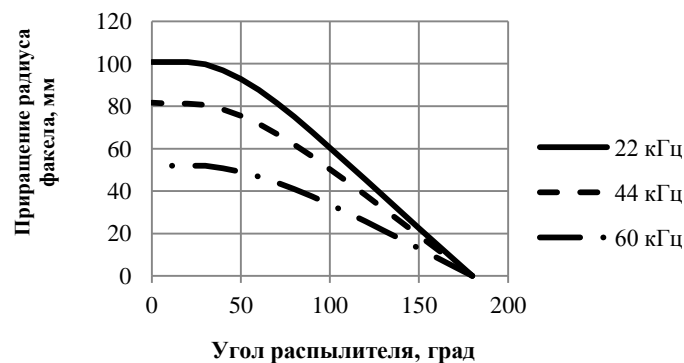
Рисунок 4 – Зависимость приращения радиуса факела распыления от угла распылителя
