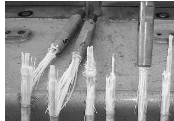
Рисунок 17 – Вид разрушений ШНС19 после статических испытаний
