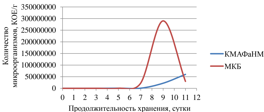
Рисунок 1 – Динамика микробиологических показателей кедрового молока в течение 11 дней после пастеризации при 75-76°C 15-20 с
